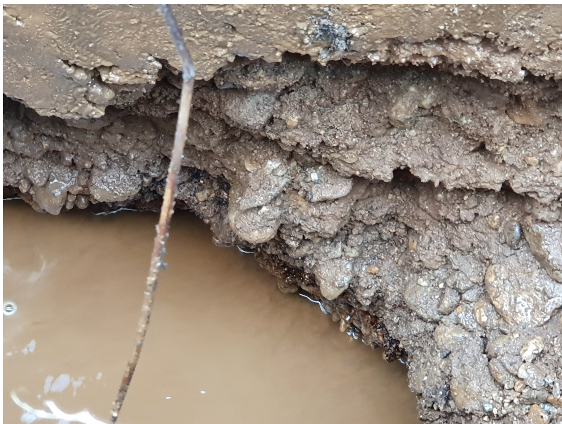
Foto 2: Detail kopané sondy-styk nadložních hlinito jílovitých písků se štěrkovými polohami.
